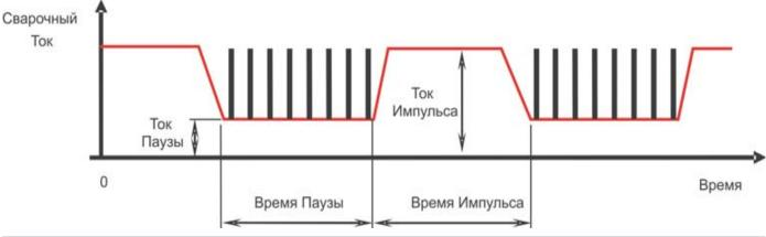
Рис. 1. Диаграмма сварочного тока при РИД-сварке.
