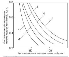
Рис. 1. Критические размеры зоны разогрева металла до 720 °C для труб с различными геометрическими параметрами, мм: 1 – 325x8; 2 – 530x9; 3 – 720x9; 4 – 1020x12; 5 – 1220x14
