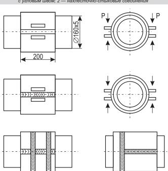
Рис. 6. Схемы сборки и сварки моделей бандажного соединения
