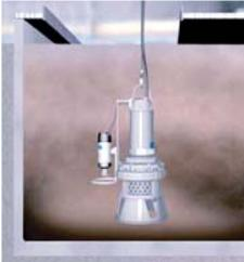
Рис. 2. К погружному шламовому насосу прикреплены две мешалки
