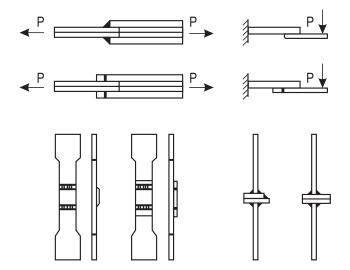
Рис. 4. Образцы для оценки служебных свойств нахлесточных сварных соединений с различным конструктивным оформлением: а — одноосное растяжение; б — испытание на изгиб; в — циклическое нагружение (растяжение);
