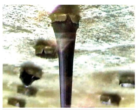
Рис. 3. Струя нефти, проваливающаяся через одно из отверстий полки.
