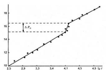
Рис. 2. ГРАФИК КВД В СКВ. 36-ОГН УНЬВИНСКОГО МЕСТОРОЖДЕНИЯ, ВСКРЫВШЕЙ ПОРОВОТРЕЩИННЫЙ КОЛЛЕКТОР
