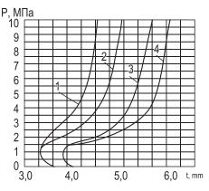
Рис. 2. Зависимость разрушающего давления Р от толщины t стенки трубы при сварке по окружности нефтепровода (1, 3 — скорость транспортировки нефти 6 м/с; 2, 4 — скорость транспортировки нефти 2 м/с) и газопровода (1, 3 — скорость транспортировки газа 20 м/с; 2, 4 — скорость транспортировки газа 6 м/с; 1, 2 — ток сварки 90 A; 3, 4 — ток сварки 140 A)
