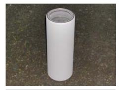
Восстановленная уплотнительная поверхность защитной гильзы насоса
