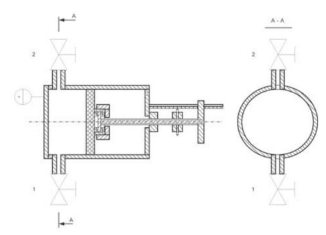
Рис. 4. Схема устройства для определения давления насыщенных паров, содержания свободных и растворенных газов в нефти
