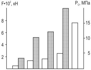
Рис. 7. Контактные давления PC (заштрихованные участки) и усилия F при осевом сдвиге в зависимости от технологии сборки и сварки бандажа на трубе: а, б, в, г, д — модели бандажных соединений (см. рис. 6)
