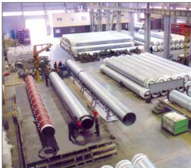
Цех теплогидроизоляции труб для нефти и газопроводов диаметром до 1220 мм
