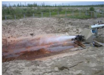
Рис. 4 — Установка ГФУ-5 на промысле
