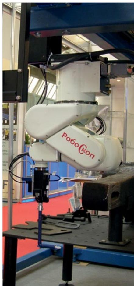
«Робоскоп 3000» — роботизированный комплекс неразрушающего контроля и лазерного обмера геометрических параметров
