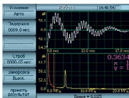
Измерения **корреляционным** методом осуществляются при наличии не менее двух донных эхо сигналов (погрешность
