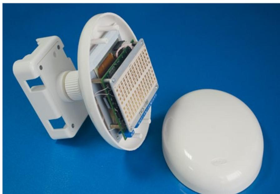
Рис. 1,2 – Электронные блоки микроволновых извещателей
