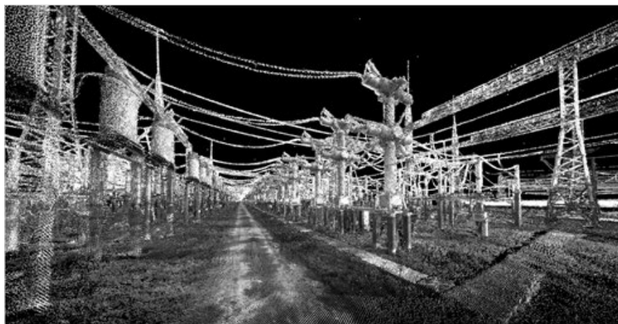
Рис. 3 — Текстурированные по фотоизображениям точки мобильного лазерного сканирования
