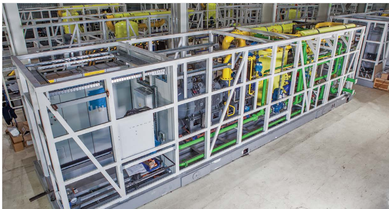
Дожимная компрессорная станция GEA для низконапорных газовых скважин, завод в г. Климовск, Московская обл.
