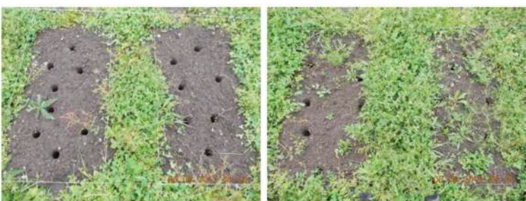
Рис. 7 — Слева направо: самозарастание загрязненных дизельным топливом контрольного и экспериментального (обработанного биодеструктором Микрозим) участков
