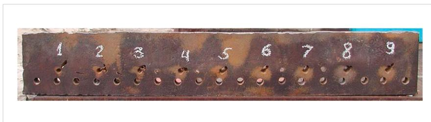
Рис. 3 — Прорезанный эталонный образец
