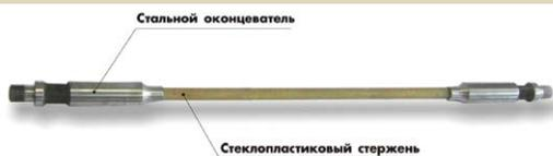
Штанга насосная стеклопластиковая (далее ШНС) состоит из стеклопластикового стержня (тело штанги), соединенного с металлическими головками. Производим ШНС длиной от 0,5 до 15 м и диаметрами стержня 22, 25, 29 мм. Классы прочности ШНС соответствуют классу прочности «Д» по ГОСТ Р 51161-2002. Рабочая температура ШНС до 130°C, морозостойкость ШНС -60°C. Гарантийный срок — до 24 месяцев, в отдельных случаях может быть увеличен до 5 лет. ШНС сертифицирована на соответствие ГОСТ Р 51161-2002.
