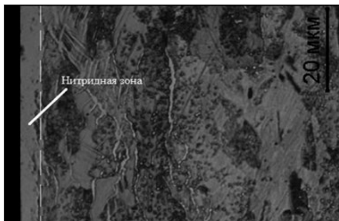
Рис. 4 — Микроструктура азотированного слоя стали 38Х2МЮА (ИПА)
