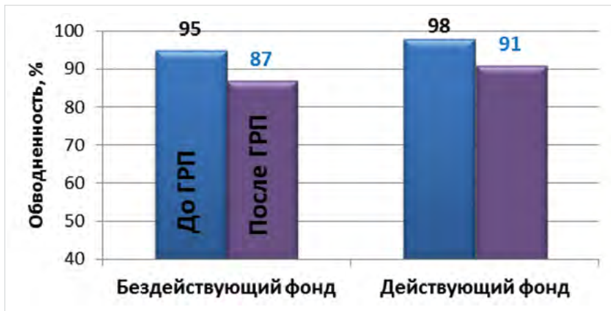
Рис. 5 — Динамика изменения обводнённости до и после ГРП Fig. 5 — Watercut reservoir condition before and after hydraulic fracturing
