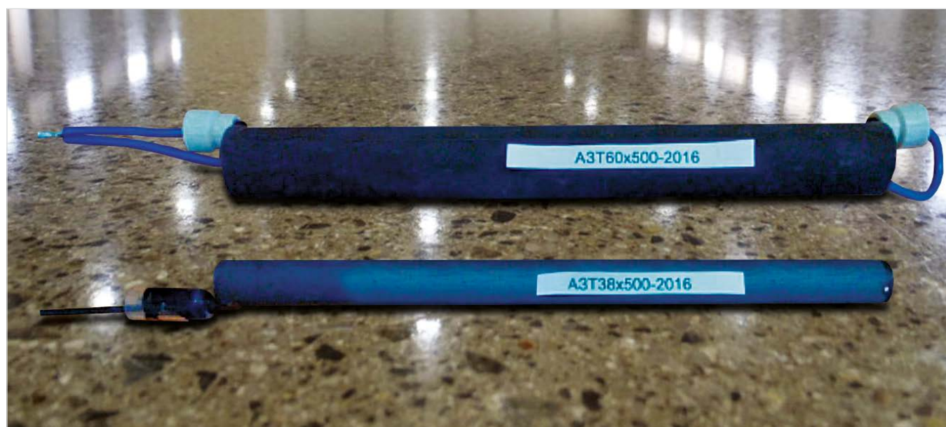
Рис. 3 — Трубчатые титановые анодные заземлители с покрытием из диоксида марганца с одним тоководом — (диаметр 38 мм) и с двумя (диаметр 60 мм)
