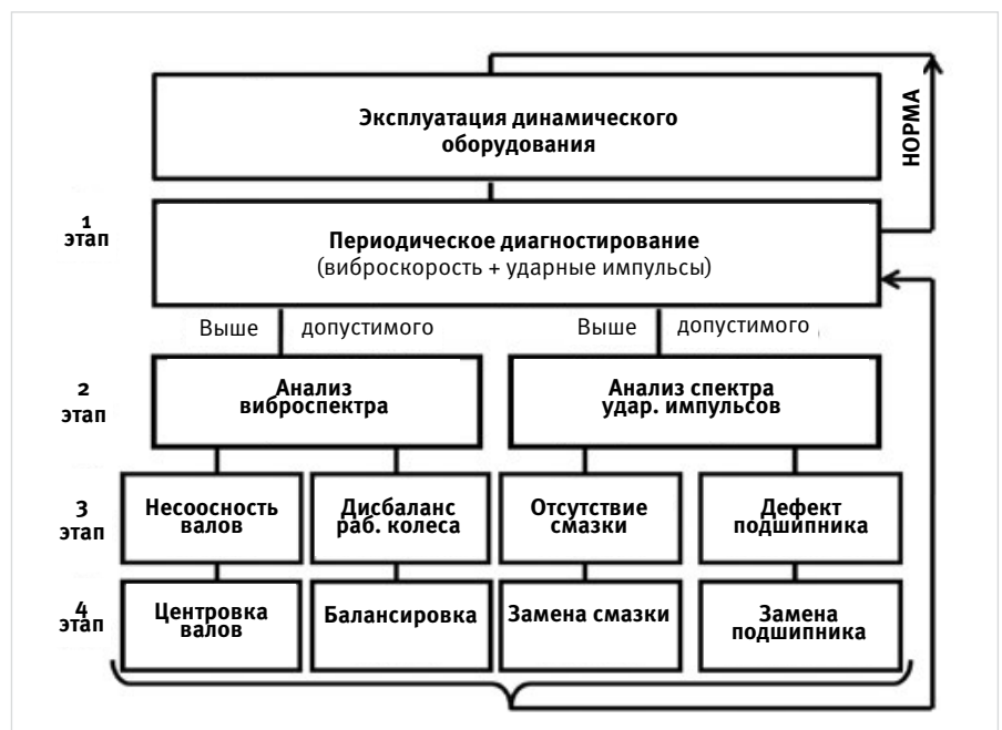
Рис. 2 — Алгоритм эксплуатации и обслуживания динамического оборудования
