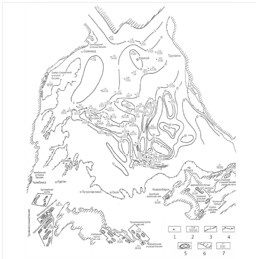
Рис. 3. Карта макроуглености ниже- и среднеюрских отложений [8]: 1 — площади, по которым замерялись угли в разрезе; 2 — в числителе — максимальная толщина угольного пласта; в знаменателе — максимальная суммарная мощность углей (макс. количество пластов угля); 3 — линии равных средних мощностей углей в разрезе J_{1-2} ; 4 — граница выклинивания J_{1-2} ; 5 — месторождения угля в юре; 6 — зона отсутствия угля в разрезе; 7 — интерпретирована 1/2–1/3 часть разреза
