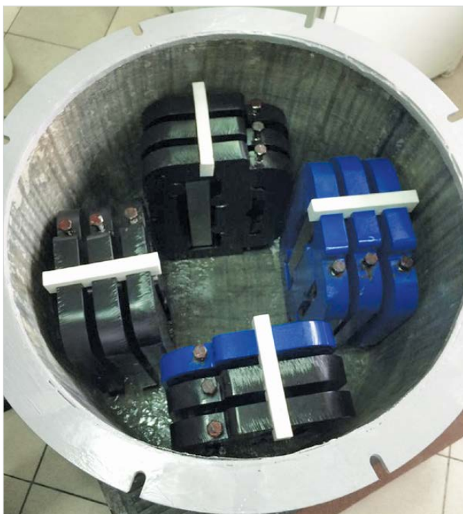
Рис. 3 — Полнотолщинные образцы в испытательной емкости
