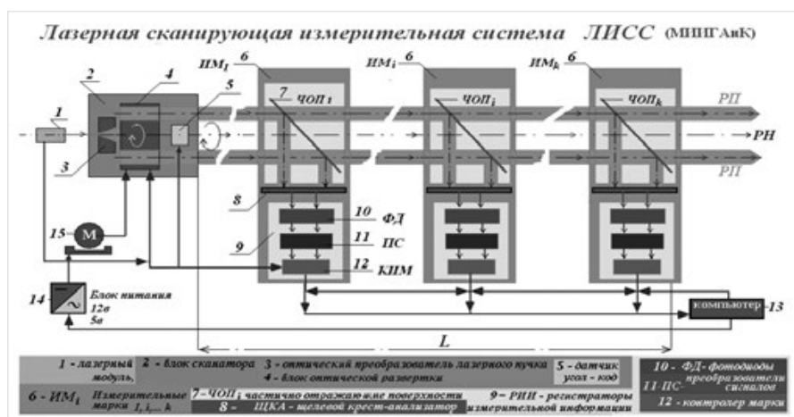
Рис.1 — Функциональная блок — схема ЛИСС
