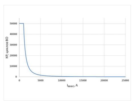
Рис. 1. Зависимость снижения ресурса выключателя от тока в момент отключения
