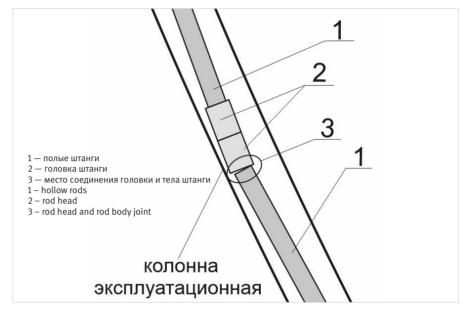
Puc. 6. Расположение полых штанг в скважине Fig. 6. Placement of hollow rods in a wellbore
