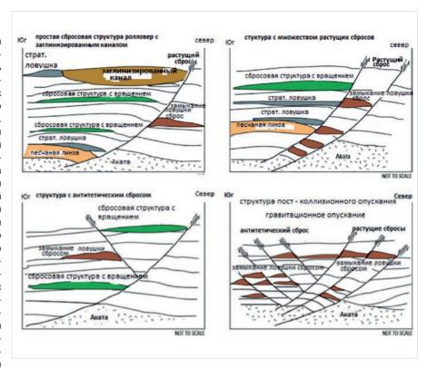
Puc. 5. Примеры структур нефтяных месторождений дельты р. Нигер и связанных с ними ловушек. Стрелки показывают направление движения сбросов [8] Fig. 5. Examples of structures of oil fields of the river delta Niger and related traps. Arrows show the direction of movement of discharges [8]
