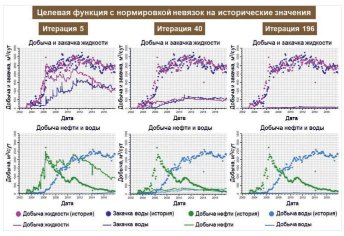
Puc. 5. Эволюция показателей разработки сектора в случае адаптации с нормировкой целевой функции на исторические значения Fig. 5. Evolution of the sector development indicators in case of history matching with objective function normalized to the observed values
