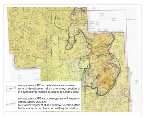
Puc. 2. Сопоставление границы зоны развития аномального разреза баженовской свиты, установленной по данным сейсмических исследований и на основе детальной корреляции скважин
