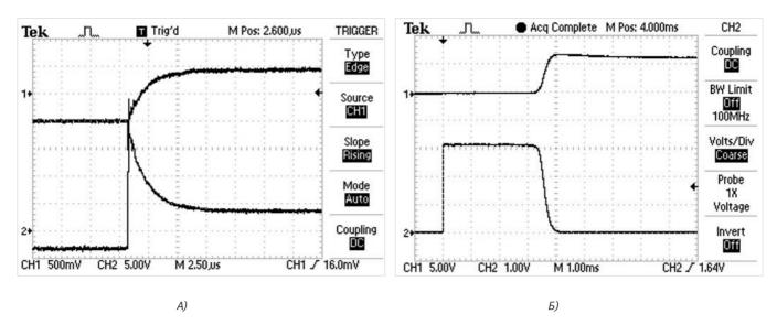
Puc. 6. Осциллограмма тока в цепи (CH1) и падения напряжения на вторичной обмотке (CH2) при нормальных условиях (A) и в криогенной среде (Б)
