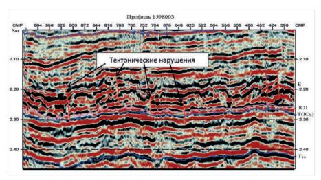
Рис. 3. Пример временного сейсмического разреза верхнеюрских — нижнемеловых отложений Тевлинско-Русскинского месторождения, фиксирующий разрывные нарушения
