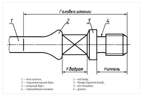
Рис. 1. Элементы насосной штанги Fig. 1. Sucker rod elements
