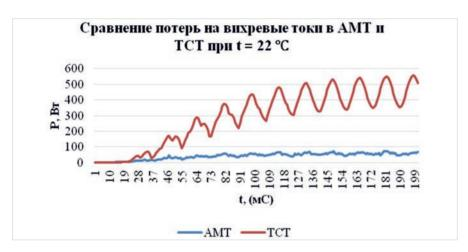
Puc. 4. Сравнение потерь на вихревые токи в AMT и TCT Fig. 4. Comparison of eddy current losses in ACT and TPT
