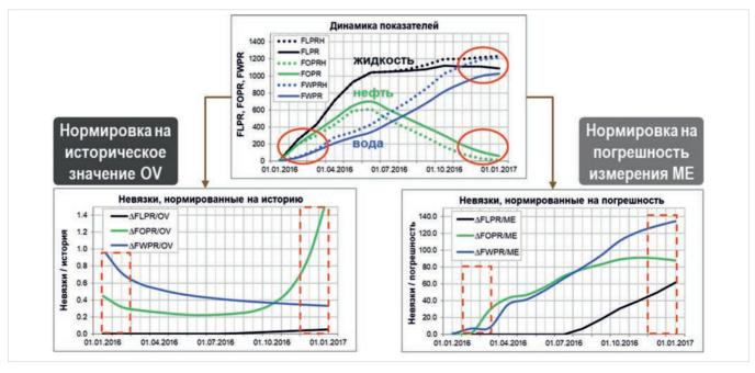
Puc. 1. Способы нормировки целевой функции Fig. 1. Objective function normalization methods
