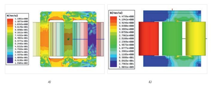
Puc. 3. Распределение магнитной индукции в АМТ (A) и ТСТ (Б) Fig. 3. Distribution of magnetic induction in ACT (A) and TPT (B)
