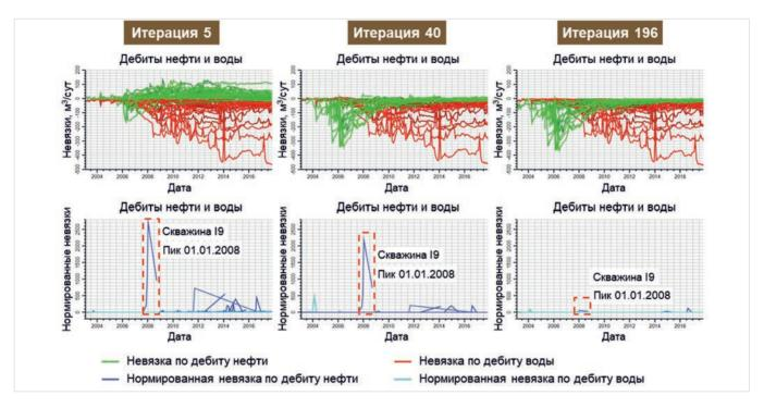
Puc. 6. Эволюция невязок при adanmaции с целевой функцией, нормированной на исторические значения Fig. 6. Mismatch evolution in case of history matching with the objective function normalized to the observed values
