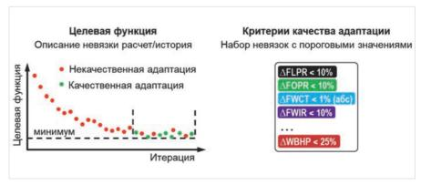
Рис. 2. Связь целевой функции с критериями качества адаптации Fig. 2. Objective function and history match quality criteria
