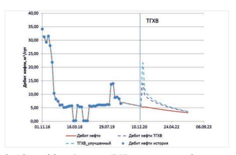
Рис. 3. Динамика дебита нефти скважины № 15 Кармалкинского месторождения Fig. 3. Dynamics of oil production from well № 15 of Karmalkinskoye field
