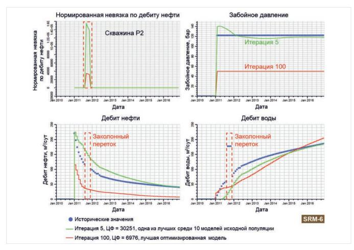
Puc. 3. Пример ухудшения качества адаптации при использовании целевой функции, нормированной на исторические значения Fig. 3. Example of history matching quality deterioration when using the objective function normalized to the observed values
