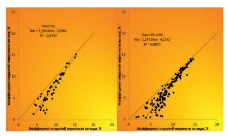
Puc. 1. Сопоставление пористости по газу и по воде пласта Ю1 (слева) и пластов Ю2 и Ю3 (справа)
