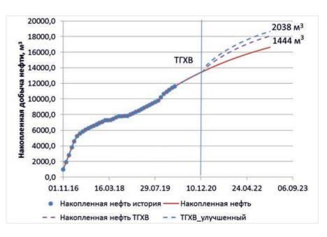
Рис. 4. Накопленная добыча нефти по скважине № 15 Кармалкинского месторождения Fig. 4. Cumulative oil production from well №15 of Karmalkinskoye field
