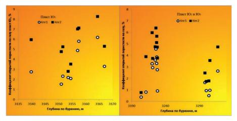
Рис. 3. Зависимость коэффициентов открытой пористости по газу от глубины бурения пласта Ю1 (слева) и пластов Ю2 и Ю3 (справа)
