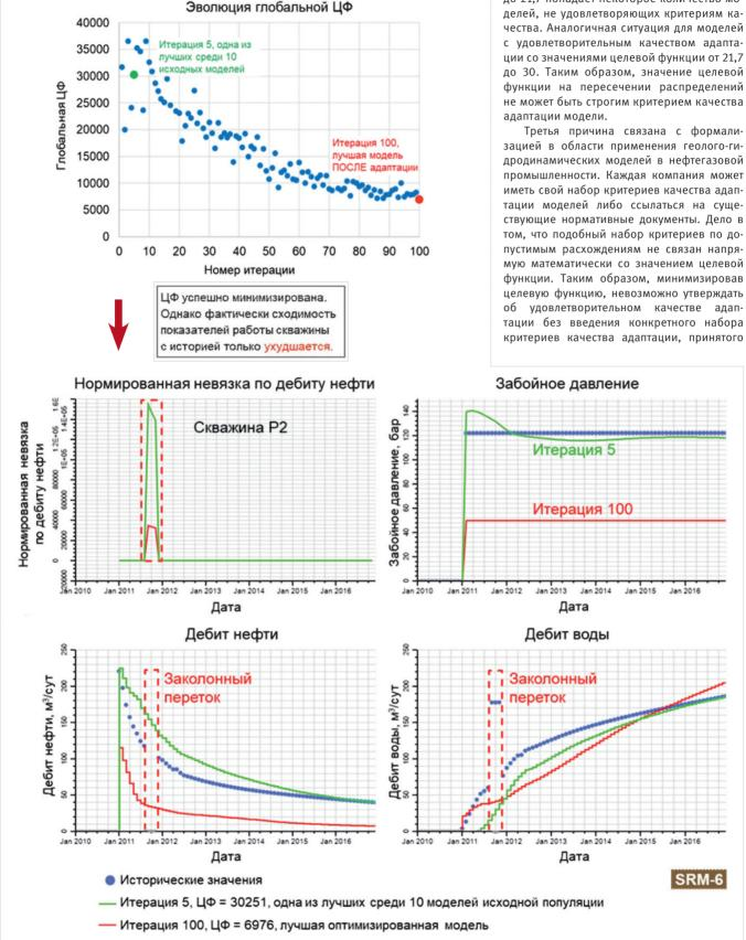
Puc. 3. Пример ухудшения качества адаптации при использовании целевой функции, нормированной на исторические значения Fig. 3. Example of history matching quality deterioration when using the objective function normalized to the observed values
