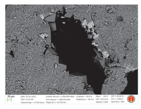
Рис. 5. Фотография образца керна, выполненная методом растровой электронной микроскопии (на фотографии изображен известняк с выраженными процессами выщелачивания и вторичной доломитизации)
