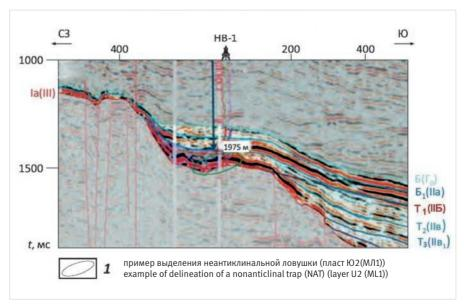
Puc. 3. Подтверждение продуктивности неантиклинальных ловушек в нижнесреднеюрском НГК (Хабейское месторождение, Южно-Таймырская моноклиза) [5]. Фрагмент временного разреза по профилям 0683015 — 0582010 — 0683013 Fig. 3. Confirmation of hydrocarbon charge of non-anticlinal traps in Lower-Middle Jurassic play (Khabeisky field, South Taimyr monoclise) [5]. Fragment of time section along 0683015 — 0582010 — 0683013 lines
