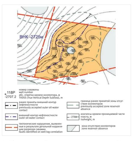
Рис. 7. Фрагмент структурной карты поверхности кровли коллектора пласта ЮСО-1/2 (верхняя пачка). Черная пунктирная линия— ранее принятый внешний контур нефтеносности, фиолетовая линия— новый Fig. 7. Fragment of the structural map on the reservoir top US 0-1/2 (top pack)
