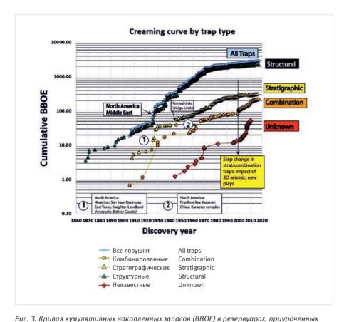
гис. Э. привим кумулянивных наконленных записов (ввос) в резервуирих, приуроченных к различным ловушкам, по годам открытия [1] Fig. 3. Curve of cumulative accumulated reserves (BBOE) in reservoirs confined to different traps, by year of discovery [1]
