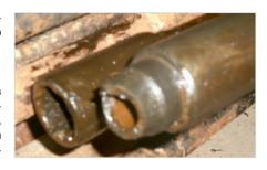
Puc. 5. Обрыв штанги на скважине № 3733 Fig. 5. Rod parting at well № 3733
