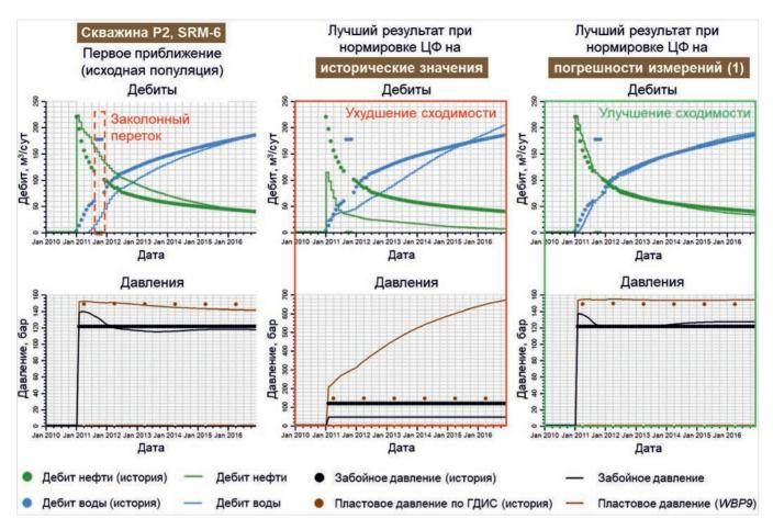
Puc. 4. Сравнение результатов adanmaции на примере скважины P2 при разных нормировках целевой функции Fig. 4. Comparison of history matching results for P2 well when using objective function normalized to the observed values and to the measurement errors
