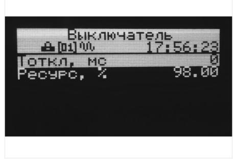
Рис. 3. Отображение оставшегося ресурса выключателя с экрана устройств БМР3
