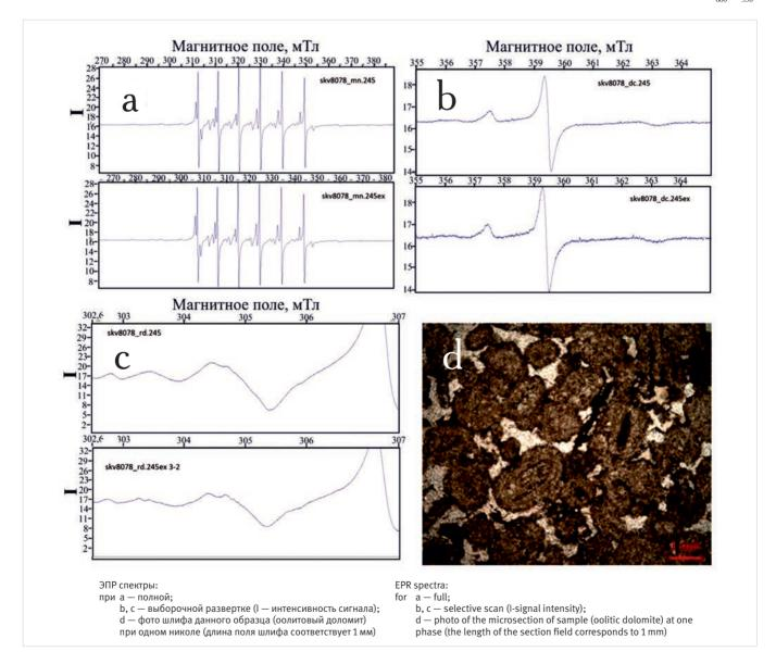
Рис. 1. Спектры ЭПР и микрофотография шлифа образца № 245 (глуб. отбора 300 м) (исходного и проэкстрагированнного) скважины № 8078
