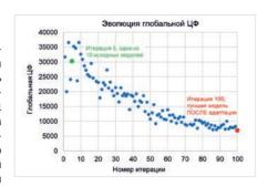
Puc. 2. Эволюция целевой функции, нормированной на исторические значения Fig. 2. Evolution of the objective function normalized to the observed values
