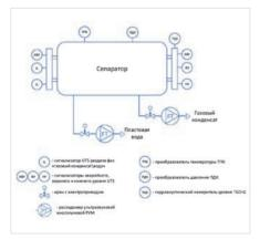
Рис. 3. Упрощенная структурная схема трехфазного сепаратора с датчиками системы удаления
