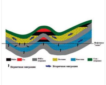
Рис. 2. Обычные и нетрадиционные ловушки и миграция (НМП — нефтематеринская порода) [3] Fig. 2. Conventional and non-traditional traps and migration [3]
