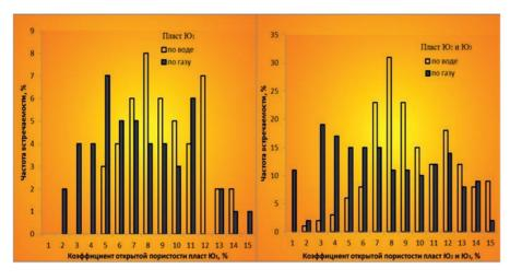
Рис. 2. Распределение значений коэффициента открытой пористости пласта Ю1 (слева) и пластов Ю2 и Ю3 (справа)
