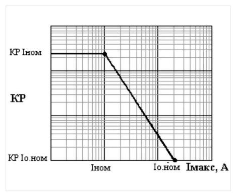
Рис. 2. Выдержка из руководства по эксплуатации: коммутационный ресурс
