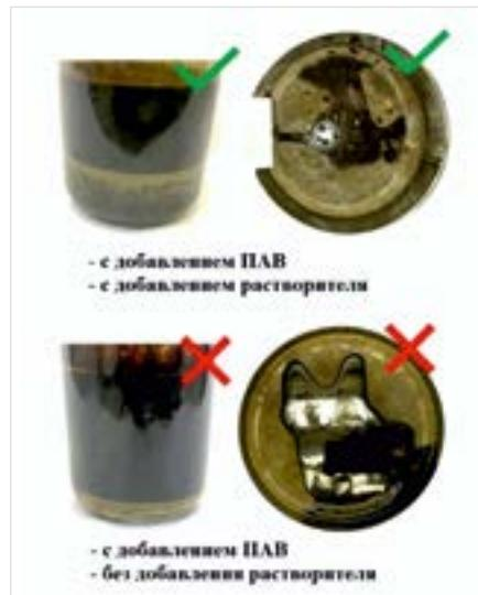
Рис. 3. Влияние добавления углеводородного реагента-растворителя на эффективность разделения эмульсии «кислотный состав – нефть» (пример) [13]
