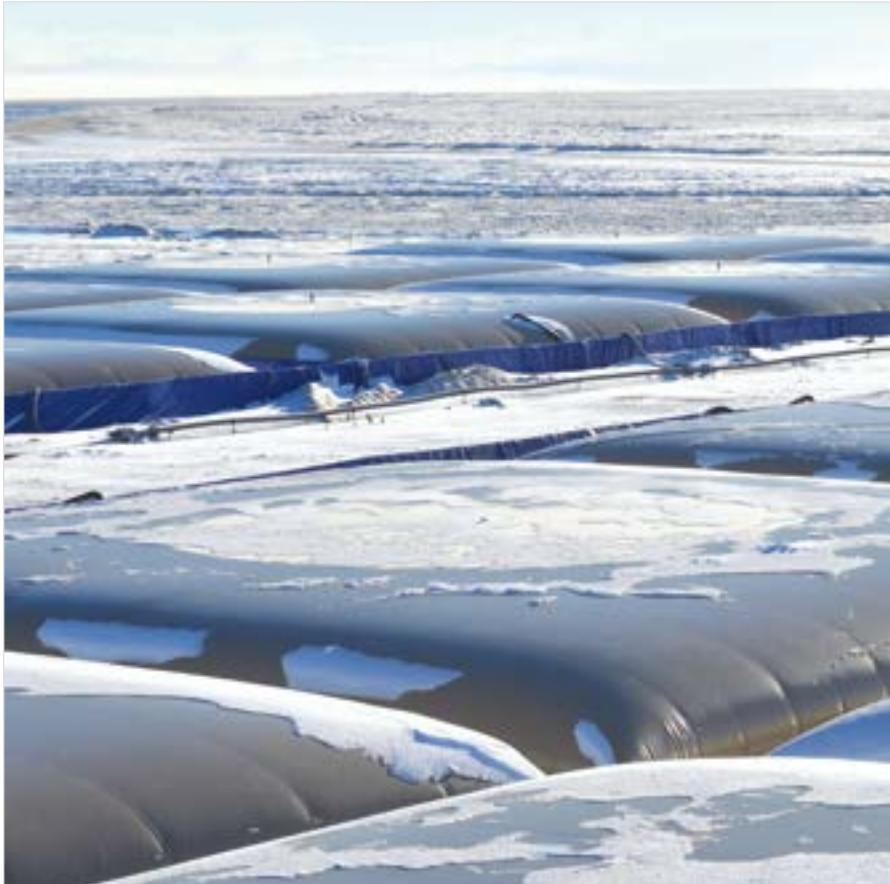
В течение 14 дней в полимерные эластичные емкости серии ПЭР-Н производился сбор ВДС, собранной в ходе ликвидации разлива. После чего «Политехника» перекачала собранную эмульсию с помощью рукавного трубопровода собственного производства на место утилизации для сепарации и очистки. Протяженность перекачки составила 22 км.
