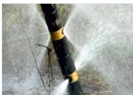
Рис. 4. Демонстрация работы гидромонитора на дневной поверхности. Производится подача пресной воды с использованием насосного агрегата СИН-32
