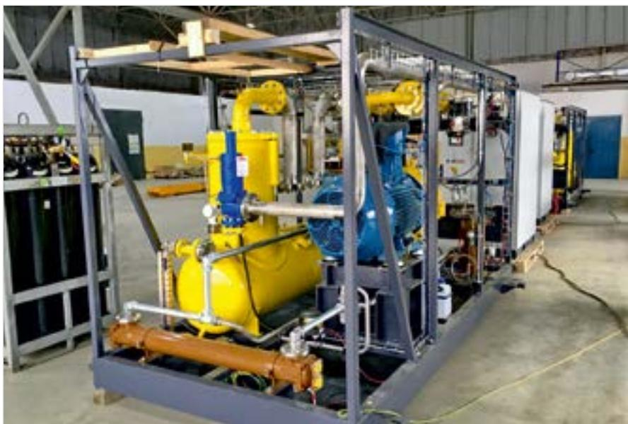
Фото 4. Установка рекуперации отпарного газа для КСПГ «Тобольск» на этапе заводских испытаний
