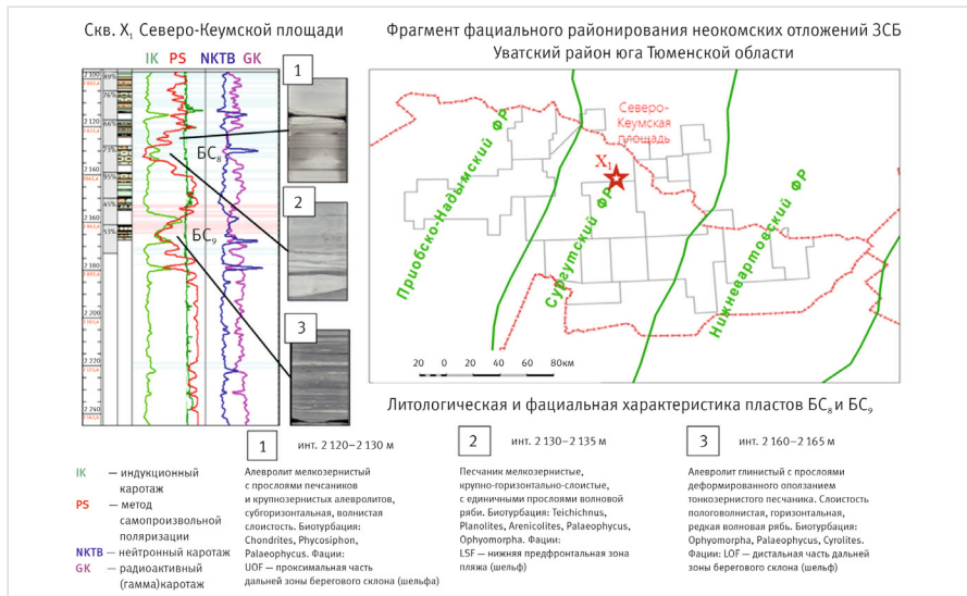
Рис. 5. Структура сургутского типа разреза на примере скважины Северо-Кеумской площади Fig. 5. The structure of the Surgut-type section on a case study of a Severokeumskaya Area well
