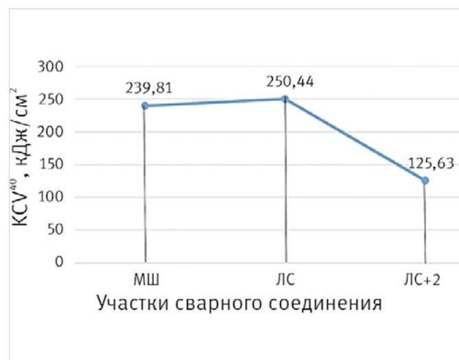
Рис. 8. График изменения ударной вязкости KCV: МШ — металл шва, ЛС — линия сплавления, ЛС+2 — основной металл на расстоянии 2 мм от линии сплавления Fig. 8. Impact viscosity change graph KCV: МШ — seam metal, ЛС — alloy line, ЛС+2 — base metal at a distance of 2 mm from the alloying line
