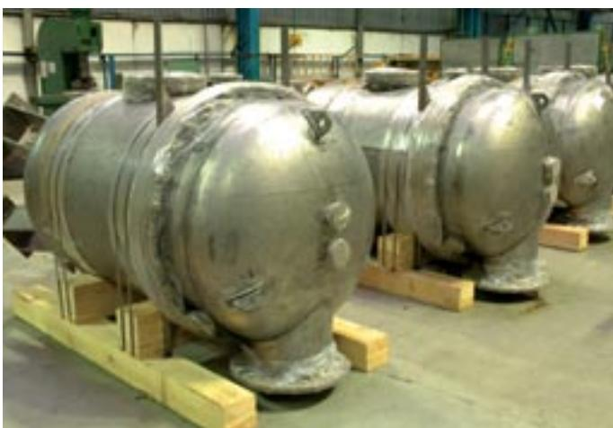
Рис.2 Корпуса фильтров фильтровальной станции тонкой очистки для месторождения «Приразломное»
