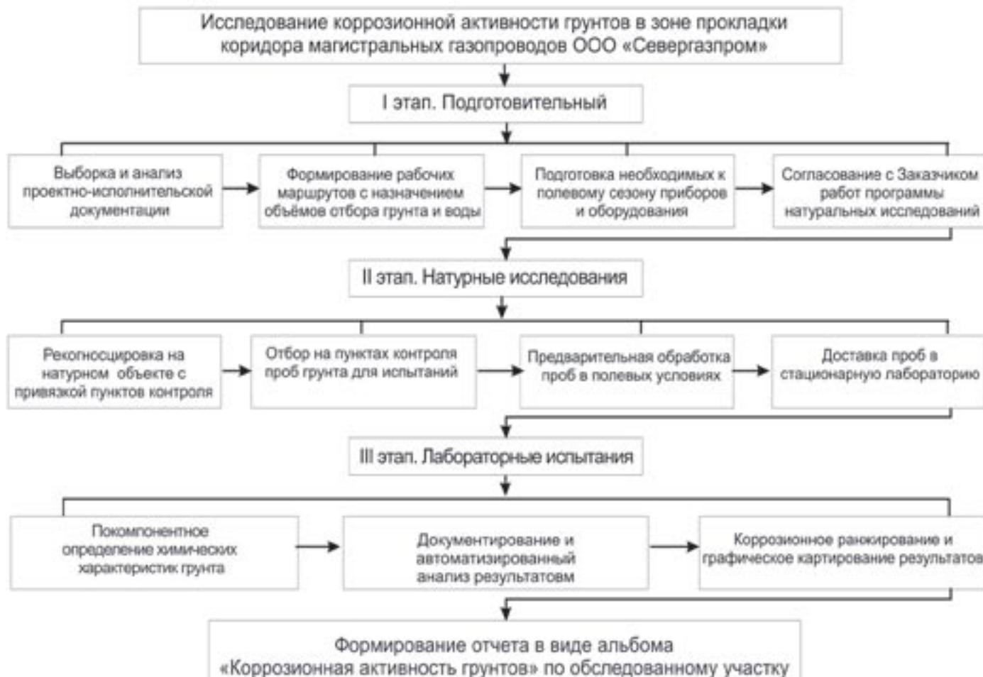
Рис.2 Структурная схема коррозионных исследований
