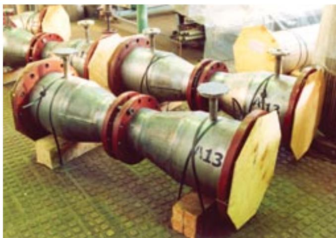
Рис.1 Элементы трубопровода из титана
