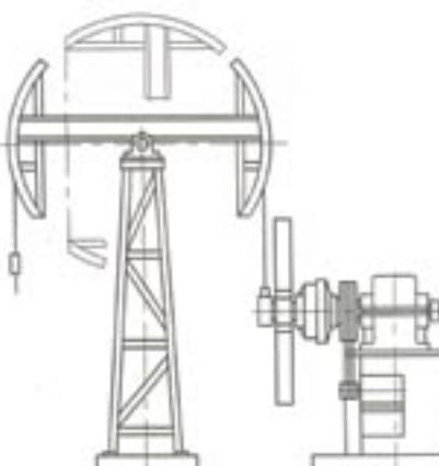
Стойка расположена симметрично по отношению к редукторам, так что ветви гибкого элемента занимают вертикальное положение. Ось стойки находится в вертикальной плоскости, перпендикулярной осям выходных валов редукторов. На стойке установлена перекладина с двумя подвижно установленными на ее концах направляющими шкивами.
