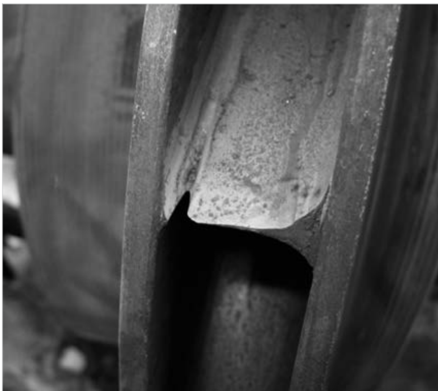
Рис. 1 — Газо-абразивный износ лопаток рабочего колеса ротора центробежного нагнетателя
