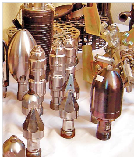
Рис. 1 — Вид на специальные устройства с сопловыми насадками и кавитаторами
