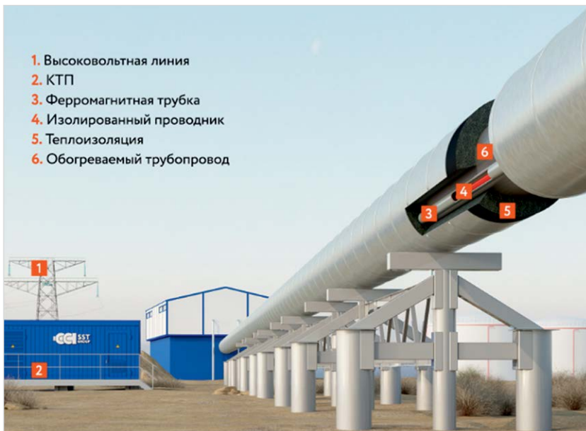
Рис. 3 — Состав системы на основе скин-эффекта ИРСН-15000
