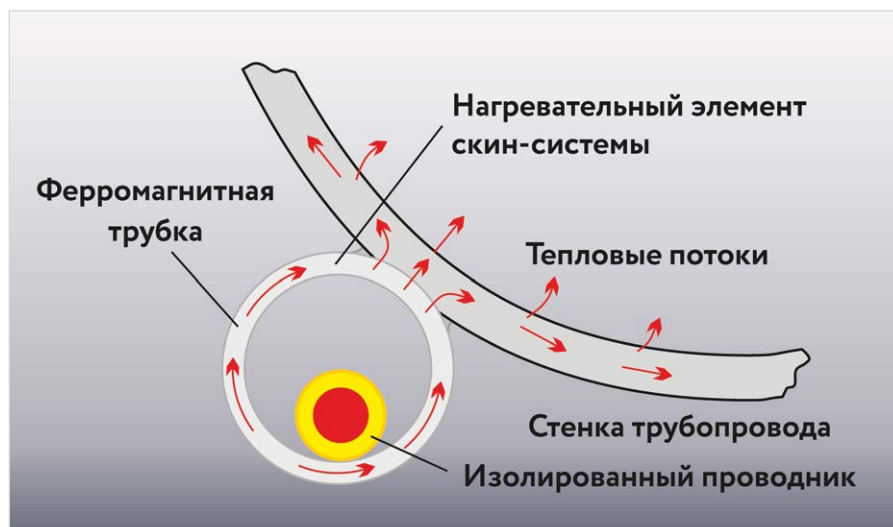
Рис. 4 — Принцип действия скин-системы основан на явлении поверхностного эффекта или скин-эффекта
