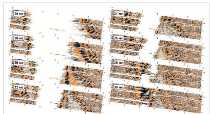
Рис. 4 — Временные срезы сейсмоакустического куба после предварительной обработки
