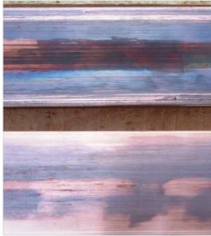
проволоке и шинах в результате окисления и наличие следов технологической смазки на твердых проволоке и шинах.
