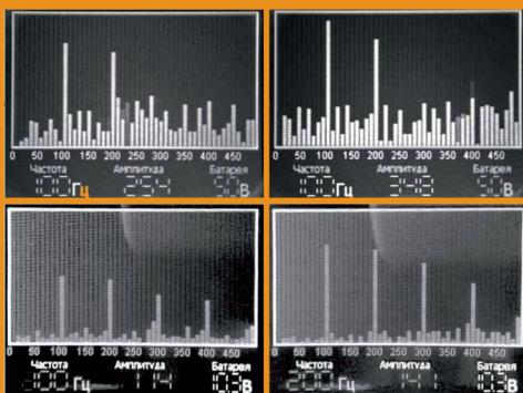
Распознать дефект можно по спектограмме. При его наличии появляются гармоники, кратные 50 или 100 Гц. Характерный вид спектра приведён на рисунке. Здесь хорошо видны спектральные составляющие 100 Гц и 200 Гц, показывающие, что принятый сигнал характеризует именно дефект изоляции, а не посторонний шум. При этом остальные гармоники меняются хаотически.
