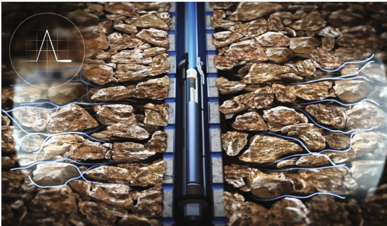
Рис. 2 — Гидравлический удар, генерируемый гидроимпульсной скважинной установкой
