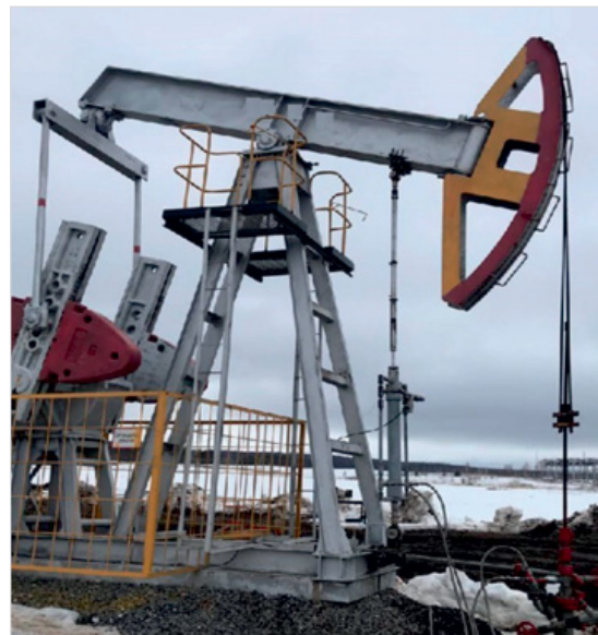
Фото 2. Компрессор скважинный, установленный на скважине
