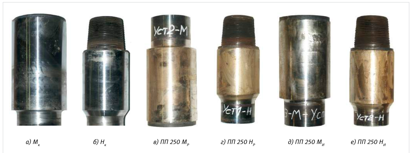
Рис. 1 — Внешний вид объектов исследования, восстановленных при различных темпах предварительного подогрева (ПП): а) Муфта без ПП; б) Ниппель без ПП; в) Муфта ПП 250°C; г) Ниппель ПП 250°C; д) Муфта ПП 250°C индуктор; е) Ниппель ПП 250°C индуктор
