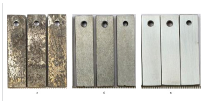
Рис. 4. Внешний вид образцов выполненных из марки стали 12X13: а — внешний вид образцов с нанесенными отложениями; б — внешний вид образцов до очистки продуктов коррозии; в — внешний вид после очистки продуктов коррозии Fig. 4. The appearance of samples made of 12X13 steel grade: а — appearance of the samples with deposited deposits; б — appearance of the samples before cleaning the corrosion products; в — appearance after cleaning the corrosion products
