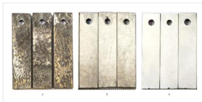
Рис. 5. Внешний вид образцов выполненных из марки стали 30X5: а — внешний вид образцов с нанесенными отложениями; б — внешний вид образцов до очистки продуктов коррозии; в — внешний вид после очистки продуктов коррозии Fig. 5. The appearance of samples made of 30X5 steel grade: а — appearance of the samples with deposited deposits; б — appearance of the samples before cleaning the corrosion products; в — appearance after cleaning the corrosion products
