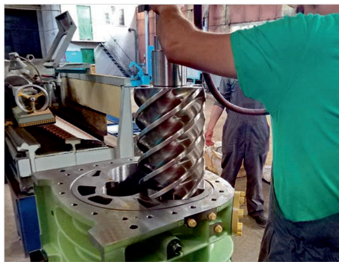
Фото 6 — Ремонт компрессоров для КС №4 «Западный Тэбук»
