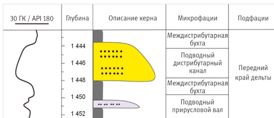
Рис. 5. Характеристика микрофации подводного дистрибутивного канала по данным ГИС и ядра (скважина D49)
