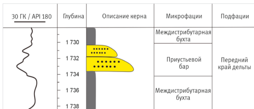
Рис. 6. Характеристика микрофации приустьевого бара по данным ГИС и ядра (скважина D26)
