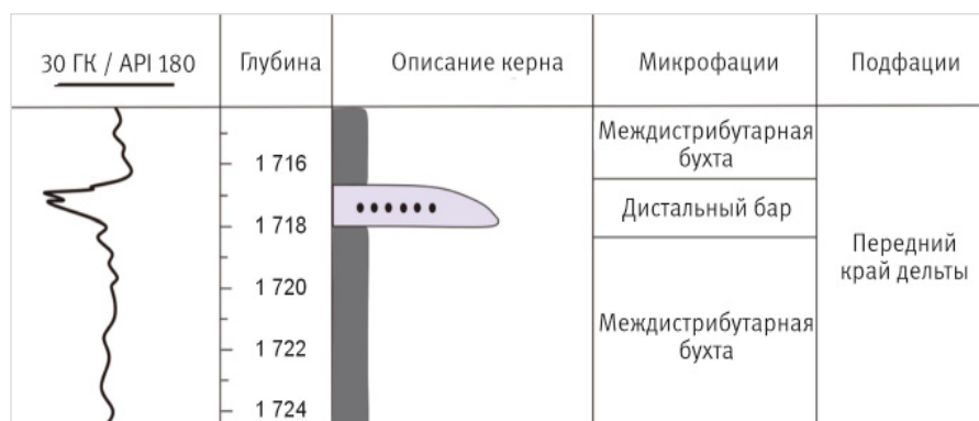
Рис. 7. Характеристика микрофации дистального бара по данным ГИС и ядра (скважина D50)
