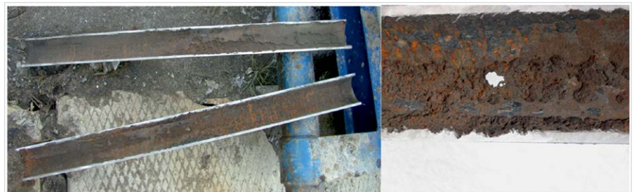
Рис. 2 — Разрез НКТ с эрозионным износом
