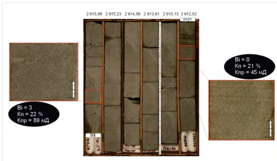
Рис. 15. Песчаники проксимальной части фронта дельты, участки с неявно выраженной биотурбацией ( Masaronichnus ). Сравнение коллекторских свойств при наличии и без биотурбации Fig. 15. Sandstones of the proximal part of the delta front, areas with unclear bioturbation ( Masaronichnus ). Comparison of reservoir properties with and without bioturbation
