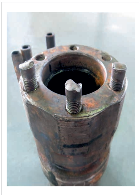
Рис. 1а — Разрушение элементов сочленения секций УЭЦН из-за вибрации Fig. 1a — The destruction of the elements of the articulation of the sections of the ESP due to vibration
