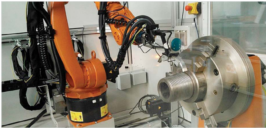
Рис. 4 — Общий вид установки для определения остаточных напряжений в резьбечных напряжениях в резьбе образца буровой трубы Fig. 4 — The installation for the determination of residual stresses in thread of drill pipe
