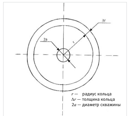
Рис. 4 — К определению плотности зондирования тока в околоскважинной среде Fig. 4 — To the determination of the density of the sensing current in the borehole environment
