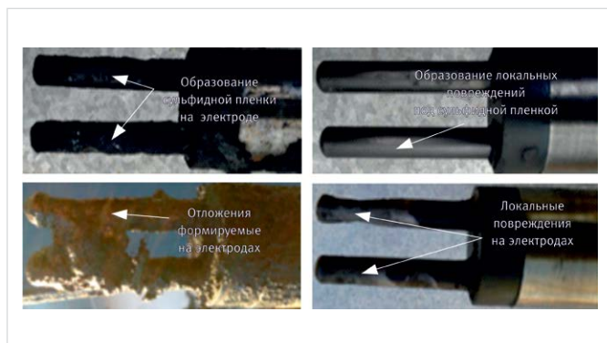
Рис. 2 — Образование отложений, создающих перемычку между электродами и сульфидной пленки
