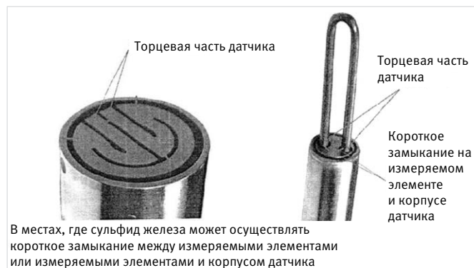
Рис. 3 — Закорачивание на проволоочных и трубчатых петлевых датчиках вследствие образования перемычки из сульфида железа
