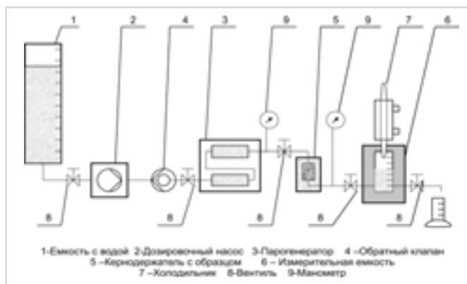
Рис. 1 Схема установки для моделирования процесса вытеснения высоковязкой нефти паром
