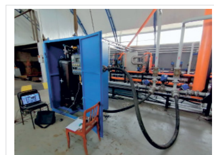
Рис. 3. Проведение исследований погрешностей на установке БИПС Fig. 3. Studying errors by means of BIPS
