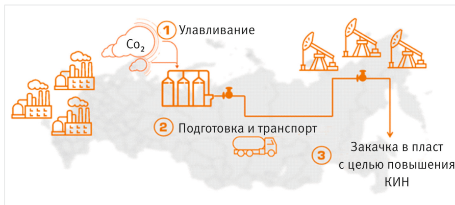
Рис. 5. Технология улавливания CO 2 и закачка его в пласт с целью увеличения КИН
