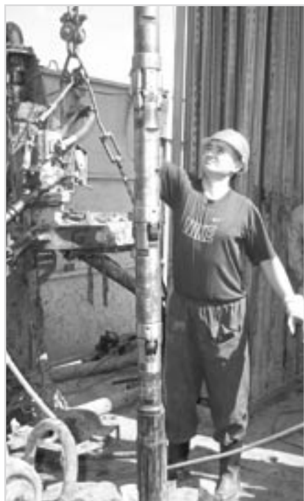
Рис. 3 Спуск компоновки развальцевателей РР-110/120М2, РРК-120/130М2, РРК-120/130 с КПТ
