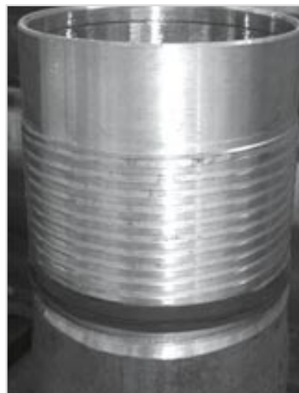
Рис. 2 Ниппель соединения с уплотнительным элементом
