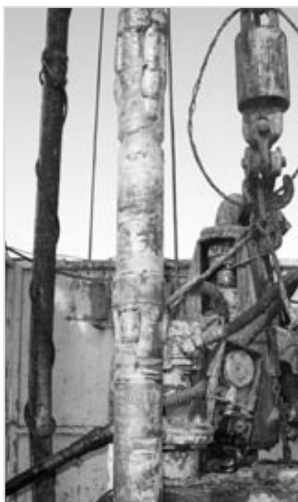
Рис. 4 Компоновка одношарошечного долота и развальцевателей РР-120/130М2 и РРК-120/130
