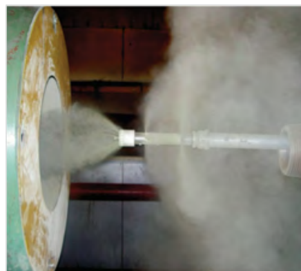
Рис. 3 — Трёх позиционное, электростатическое распыление порошка
