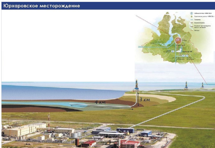
Бурение ERD* скважин *ERD (extended reach drilling) – бурение с увеличенным отклонением (отходом) от оси скважины
