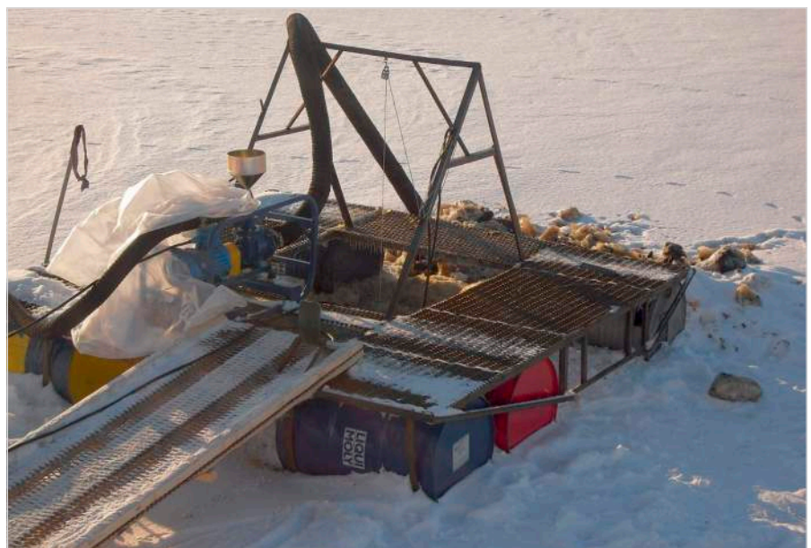
Самодельное понтонное устройство с установленной на ней грязевой помпой. Вода для размыва подается на зафиксированный ствол брандспойта
