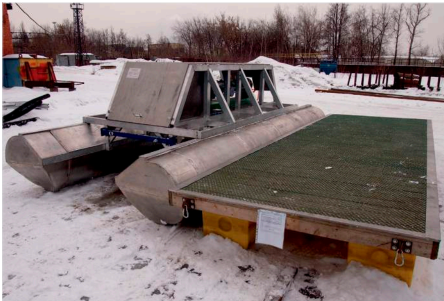
Плавающая платформа НПП. Совместная разработка НПО Декантер и Alfa Laval. Оборудована регулируемым заборным устройством и размывающими форсунками. За счет лебедок может передвигаться как «на лыжах» даже по дну амбара
