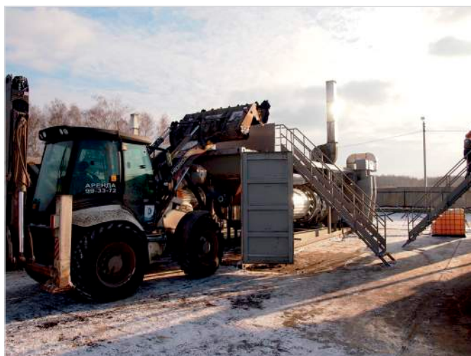
Загрузка шлама в термодеструкционную установку трактором с экскаваторными навесками разного типа
