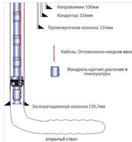
Рис. 7 — Система постоянного мониторинга работы газлифтных скважин Fig. 7 — The monitoring system of gas lift wells servisen
