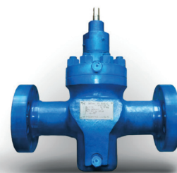
Задвижка фонтанная серии НТ-ЗФМ Ду 50-150 мм Ру 70 МПа
