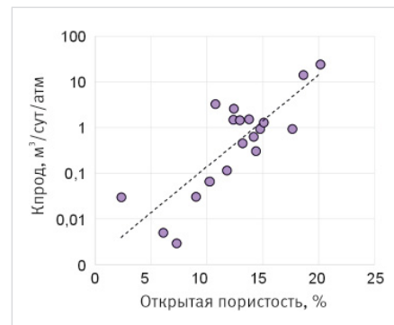
Рис. 6. Сопоставление коэффициента открытой пористости (%) и коэффициента продуктивности ( m^3/сут/атм ) Fig. 6. Comparison of productivity factor ( m^3/day/atm ) and open porosity (%)
