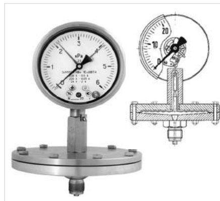
Рис. 3 — Вид и конструкция взрывозащищенного напоромера ЭкМ100/120 НВмЕх
