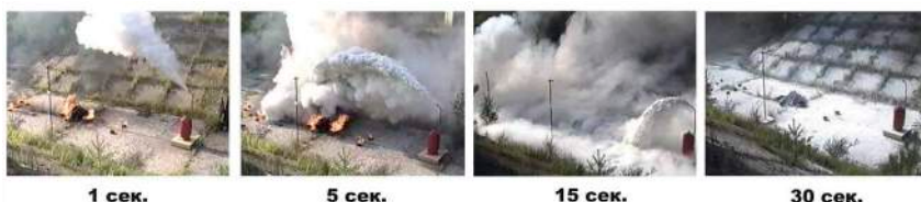
Рис. 2 — Принцип работы аэрозольно-порошкового модуля ОПАН-100 с твердотопливным газогенератором наддува
