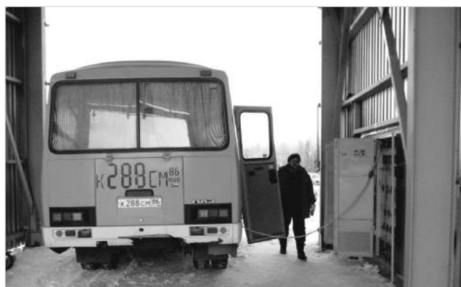
Рис. 5 — ПВиАГ на месте эксплуатации (проводятся работы по выпуску природного газа из газобаллонной системы автобуса)
